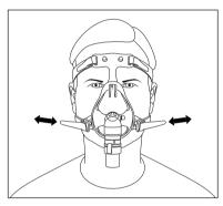
Stellen Sie die beiden unteren Bänder der Kopfhalterung A3 und A4 so ein, dass eine bequeme Spannung erreicht wird.
