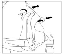
Verändern Sie bei Bedarf den Winkel der Stirnstütze. Drücken Sie dazu die Einstellflügel zusammen. Die Stirnstütze muss in eines der Löcher einrasten.
