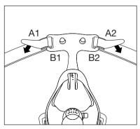
Ziehen Sie die oberen Bänder der Kopfhalterung A1 und A2 durch die Öffnungen in der Stirnstütze B1 und B2. Vergewissern Sie sich, dass die Klettbandseite der Kopfhalterung nach außen zeigt. Befestigen Sie die beiden Klettbänder A1 und A2.
