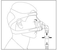
Drücken Sie die beiden Halteklammern des Schnellverschlusses zusammen und ziehen Sie den Schlauch von der Maske ab.
