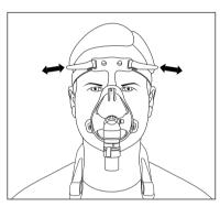
Stellen Sie die oberen Bänder A1 und A2 so ein, dass eine bequeme Spannung erreicht wird.
